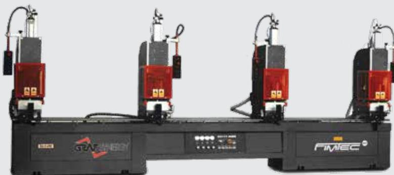
Универсальная четырехголовочная сварочная машина с поворачиваемыми головами. V-образное вваривание импоста за один рабочий цикл благодаря выравниванию обеих сварочных голов. Быстрое переключение со сварки углового соединения на T-образное соединение.
