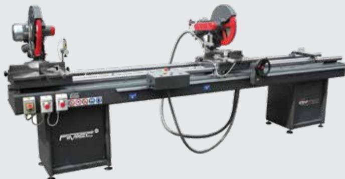
Двухголовочная полуавтоматическая пила предназначена для распиловки основного профиля при производстве светопрозрачных конструкций из ПВХ и алюминиевого профиля. Левая голова фиксирована, правая подвижная.
